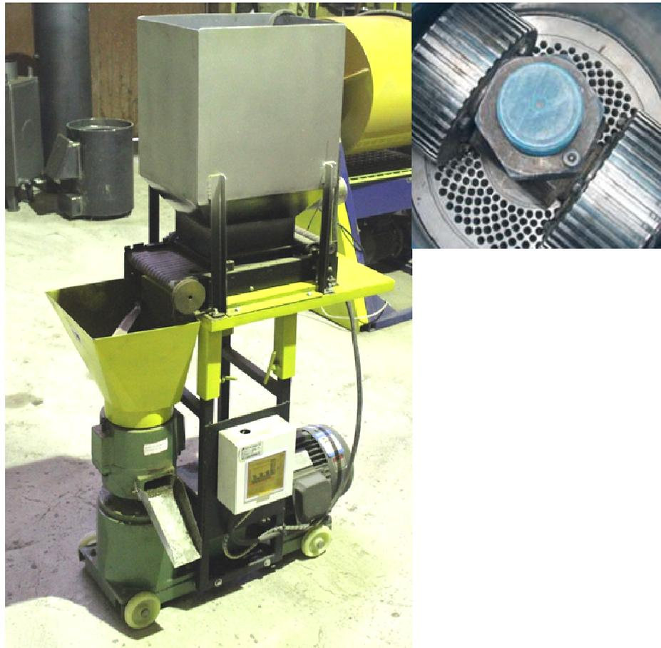
Fig. 4. Flat die extrusion granulator ZLSP150B
