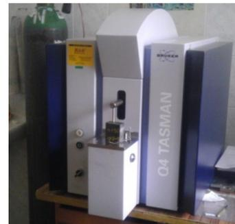
Fig. 8. Spectrometer BRUKER Q4 TASMAN
