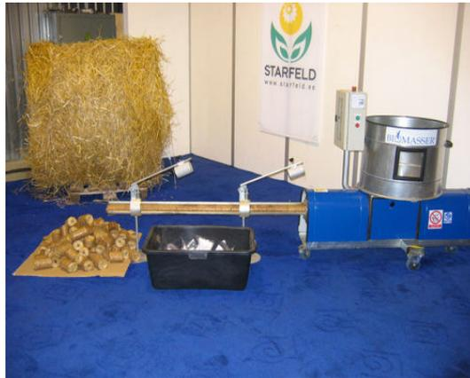
Fig. 1. Briquette press BIOMASSER BS06
